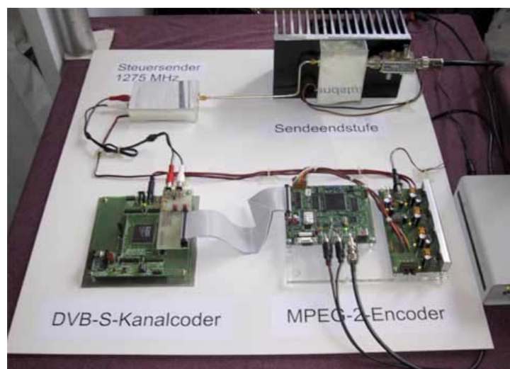
Bild 4 – Prototyp DVB-S D-ATV Sender, wie Bild 2 (beigestellt von Thomas Sailer HB9JNX / AE4WA, u.a.)
