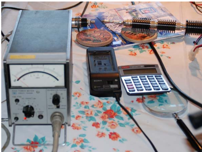
Bild 5 – HP Modell 432A Leistungs-Messer Man beachte die Ansammlung der Dämpfungs- Glieder am oberen Bild-Rand des Fotos
