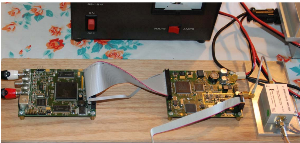
Bild 2 – Schaltungs-Aufbau mit MPEG-2-Platine, MiniMod-Modulator und Kuhne Vorstufen-PA
